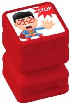
С помощью блока «Stop» («Стоп») можно остановить электромотор робота на определенное время.
