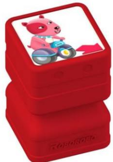
Блок «Forward» («Вперед») Вы можете сделать так, чтобы электромотор вращался в одном направлении, с помощью блока «Forward» («Вперед»).
