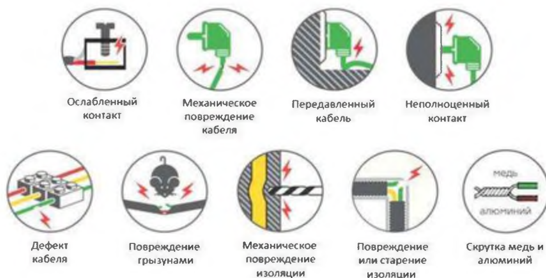
Рисунок 6. Возможные причины искрения в электропроводке
