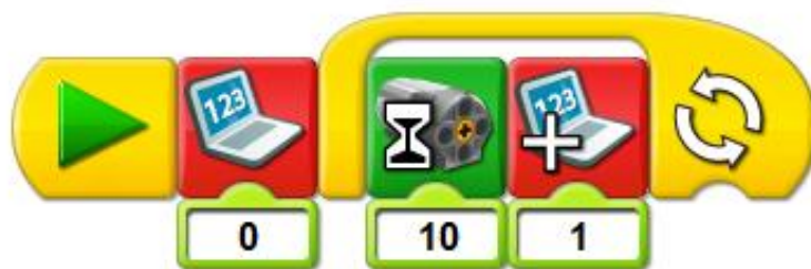
Рис. 59 Программная строка с блоком «Прибавить к Экрану» (WeDo 1.0)
