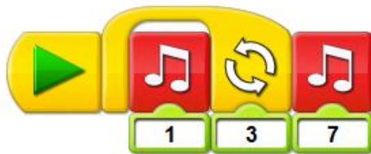
Рис. 57 Программная строка с блоком «Цикл» (WeDo 1.0)
