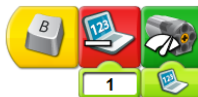
Рис. 62 Программная строка с блоком «Вычесть с Экрана» (WeDo 1.0)
