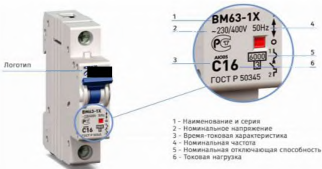
Рисунок 2. Пример маркировки АВ
