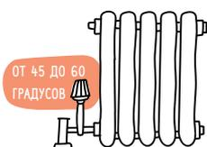
6. Установите на радиаторы отопления (батареи) терморегуляторы – специальные устройства, которые позволяют регулировать температуру в каждой отдельной комнате до нужного уровня, чтобы избежать «перетопа» и оплаты избыточного тепла в помещении.
